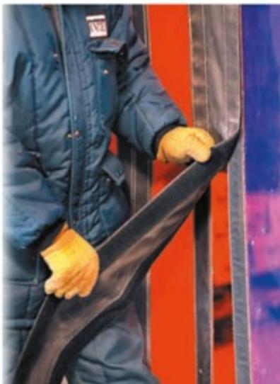
Los paneles de vinilo transparente resistentes a la luz ultravioleta se conectan con Velcro. Esto proporciona una manera segura y fácil de volver a colocar si los montacargas o los patines de carga impactan y separan los paneles.
